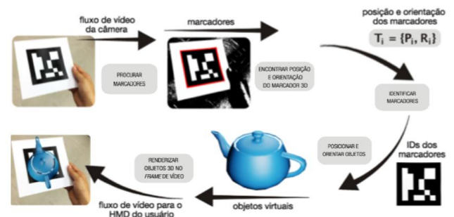
Figura 2: Processo de captura e identificação de marcadores.
